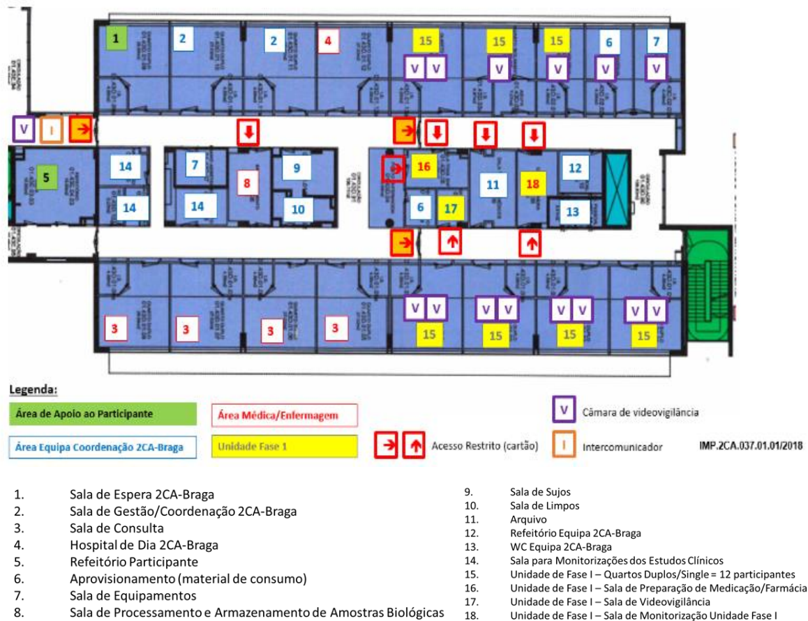
Figura 1 – Planta Instalações do 2CA-Braga
